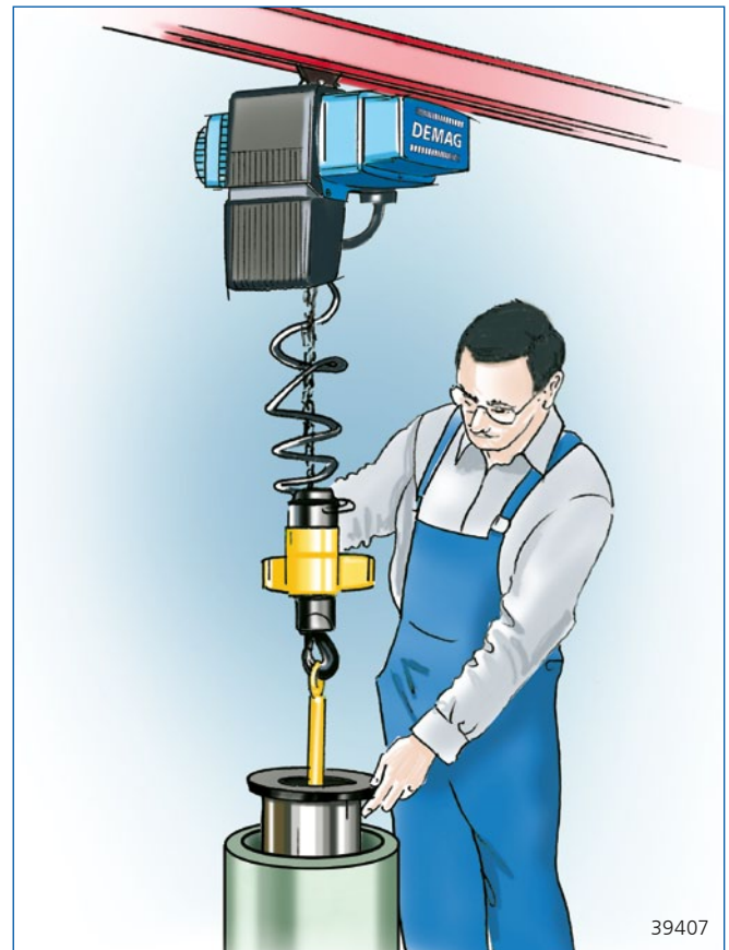
Sanftes und passgenaues Positionieren einer Spule in einer Abwicklungsvorrichtung
